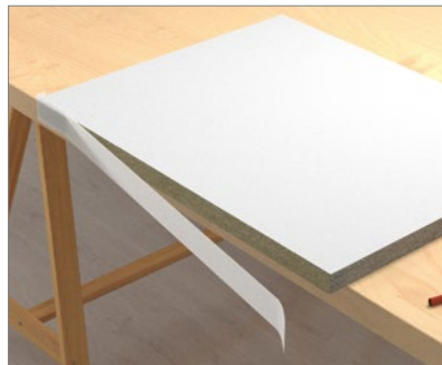
3. Tilpass med 5 mm overlapp på forsiden og trykk.
